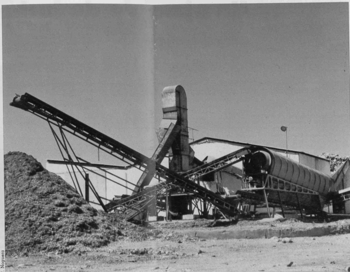
En el tubo cilíndrico —tromel— se separa la basura por tamaños. Luego pasa al molino, donde se tritura, y lo que cae es materia orgánica. La escena corresponde a la planta de Alcázar de San Juan.
